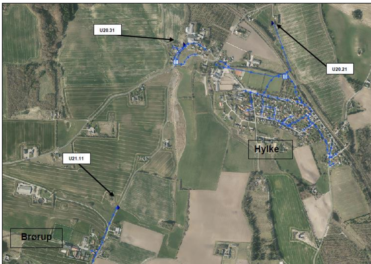
Figur 1: Oversigt over ledningsnettet i Hylke og Brørup samt placering af udløb U21.11, U20.21 og U20.31.
